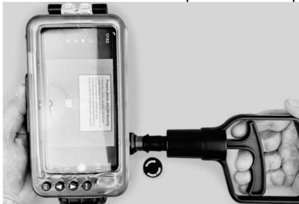
Pompa manuale premuta sull'attacco per il controllo del vuoto
