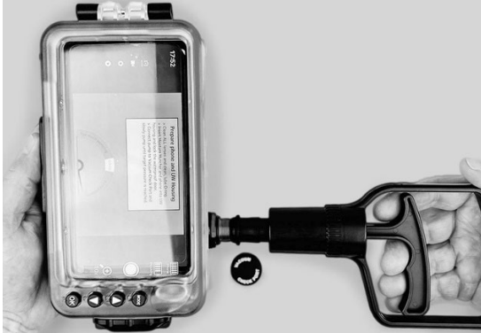
Handpumpe gegen den Vakuum-Checkport drücken
