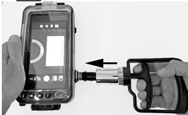
Pompa manuale premuta sull'attacco per il controllo del vuoto
