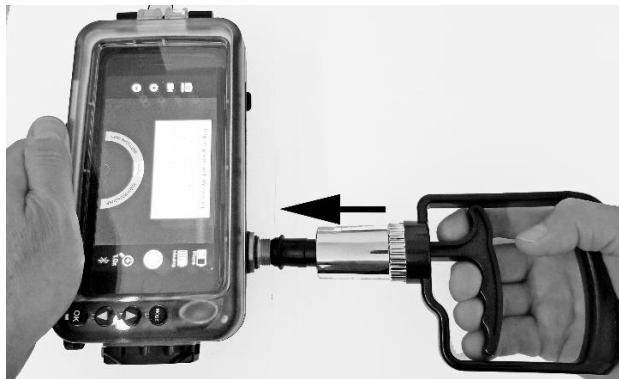
Pompe manuelle appuyée contre le port du contrôle de vide
