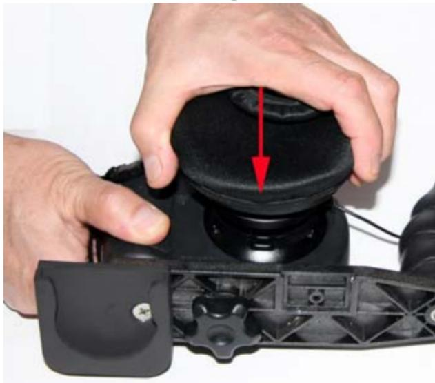
Empuje la lente en el puerto de la lente de cualquier cámara subacuática SeaLife serie "DC". El objetivo puede colocarse en la superficie o bajo el agua. Cuando entre en el agua, asegúrese de quitar las
