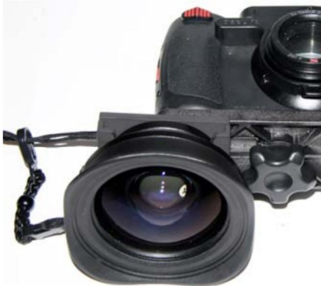
Para evitar que el objetivo se caiga o se pierda, coloque el soporte de retención en la cámara como se muestra. Cuando no vaya a utilizar el objetivo, colóquelo en la bahía del objetivo para fijarlo y protegerlo.
